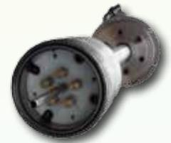
Federnde Kontaktstücke mit Kühlwasserzufuhr
