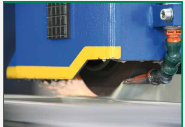
Flachscheifen von Distanzringen, das maßgeblich für die Rundlaufabweichung unserer Spindeln verantwortlich ist. Flat grinding of distance rings, which is in particular responsible for the concentricity deviation of our spindles.
